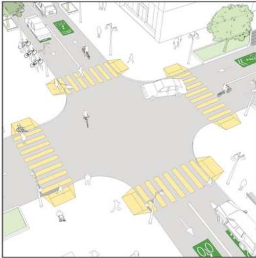
Figure 35 Intersection favorisant l'accessibilité universelle i
